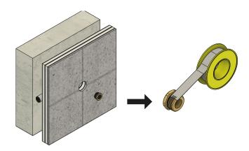
Setzen Sie das Verbinderstück in die Zierblende und schrauben Sie beide Teile in den Gewindeadapter.
