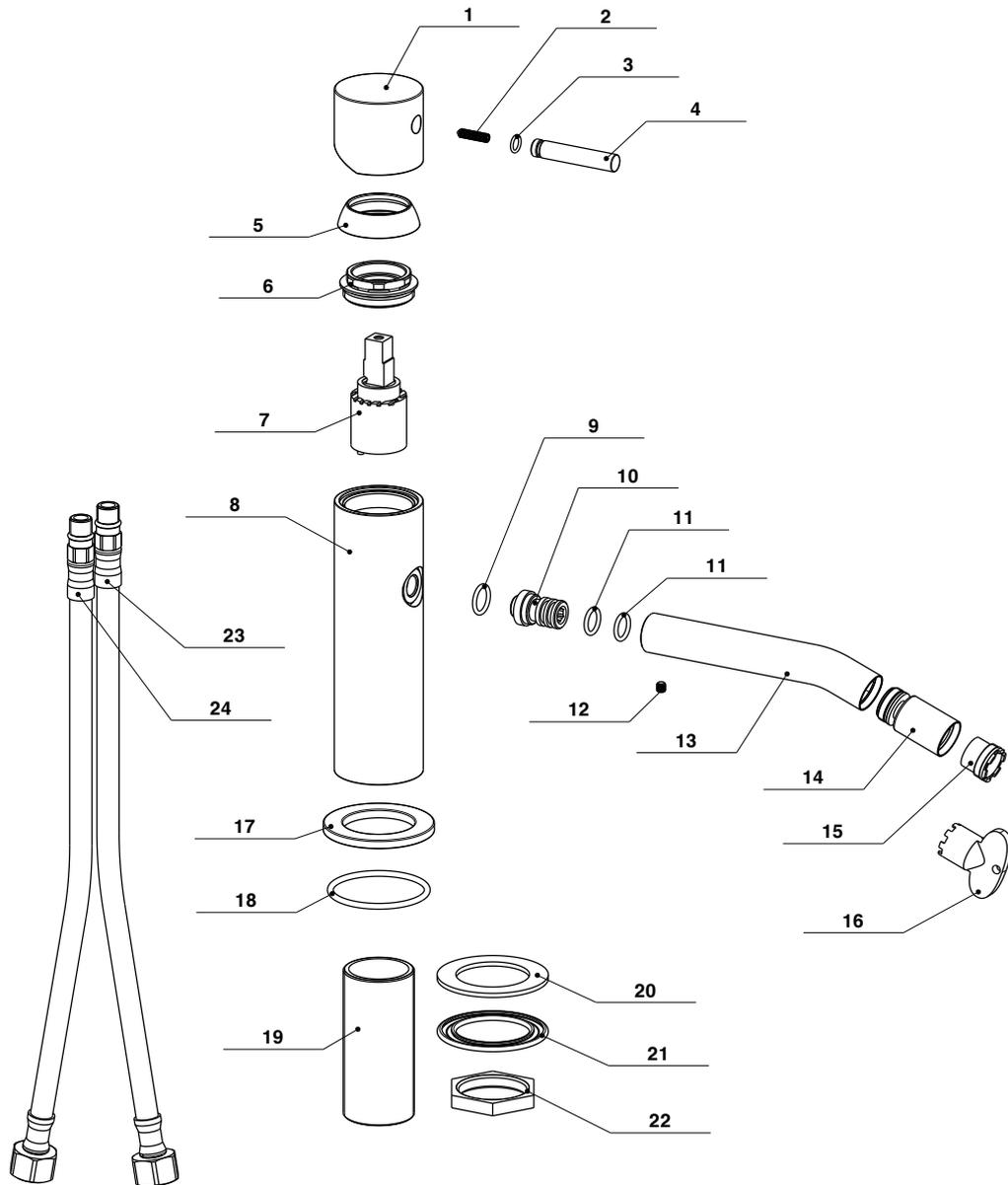
In Verbindung mit der Explosionszeichnung sind im Folgenden alle Einzelteile der Armatur inkl. Artikelnummern aufgelistet. Sämtliche Ersatzteile können direkt über VALLONE® bezogen werden. Bei Fragen zu den Ersatzteilen helfen wir gerne.
