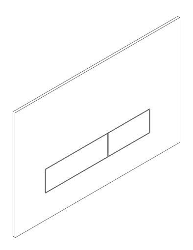
Mechanische WC-Betätigungsplatte für 2-Mengen-Spülung Mechanical toilet push plate for dual flush mounting material
