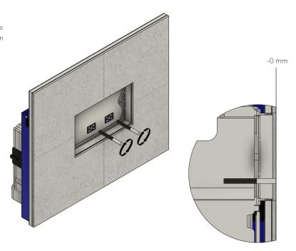
Setzen Sie die beiden Distanzbolzen in die vorgesehene Aufnahme im Spülkasten. Die Enden beider Distanzbolzen sollten 10mm unterhalb des Fliesenspiegels sitzen, wie auf der Skizze gezeigt.
