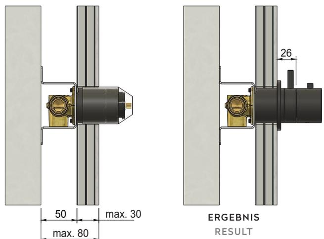
Alle Maße in Millimetern. UP-Einheit DB 2 ist in Edelstahl und pulverbeschichtetem Messing erhältlich, Produktabbildungen sind beispielhaft.
