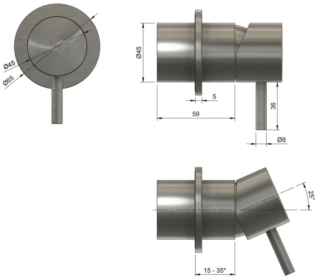
\* Maß ist abhängig von der Einbautiefe der Unterputzeinheit UP-Einheit WT 1
