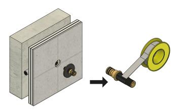
Befestigen Sie nun den Auslauf auf dem Verbinderstück wie auf der Skizze dargestellt. Auf der Unterseite des Auslaufs wird dieser mit einer Madenschraube gesichert.
