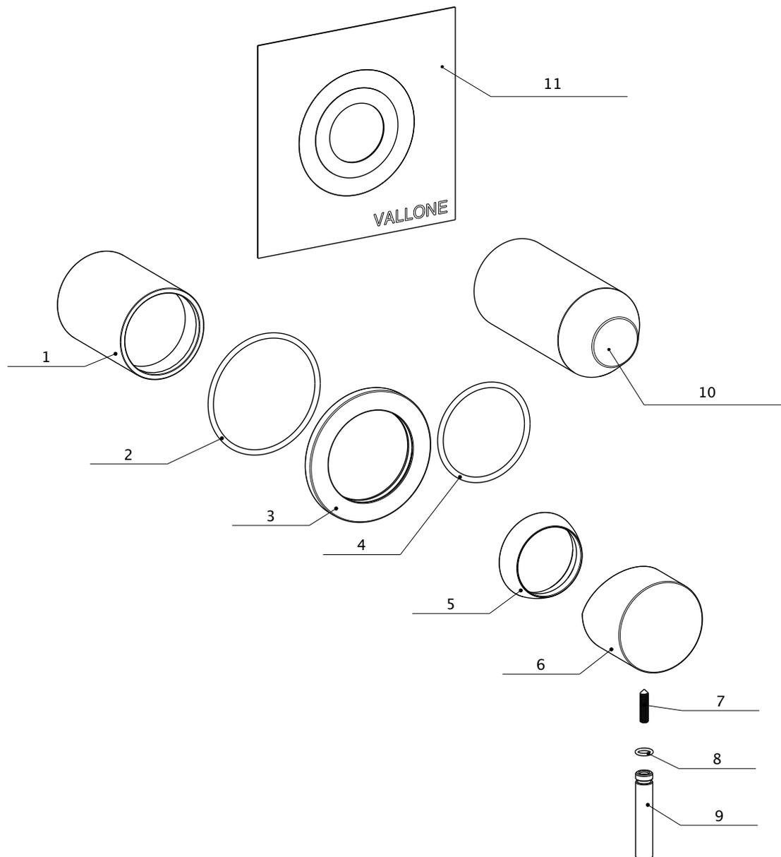
In Verbindung mit der Explosionszeichnung sind im Folgenden alle Einzelteile der Armatur inkl. Artikelnummern aufgelistet. Sämtliche Ersatzteile können direkt über VALLONE® bezogen werden. Bei Fragen zu den Ersatzteilen helfen wir gerne.
