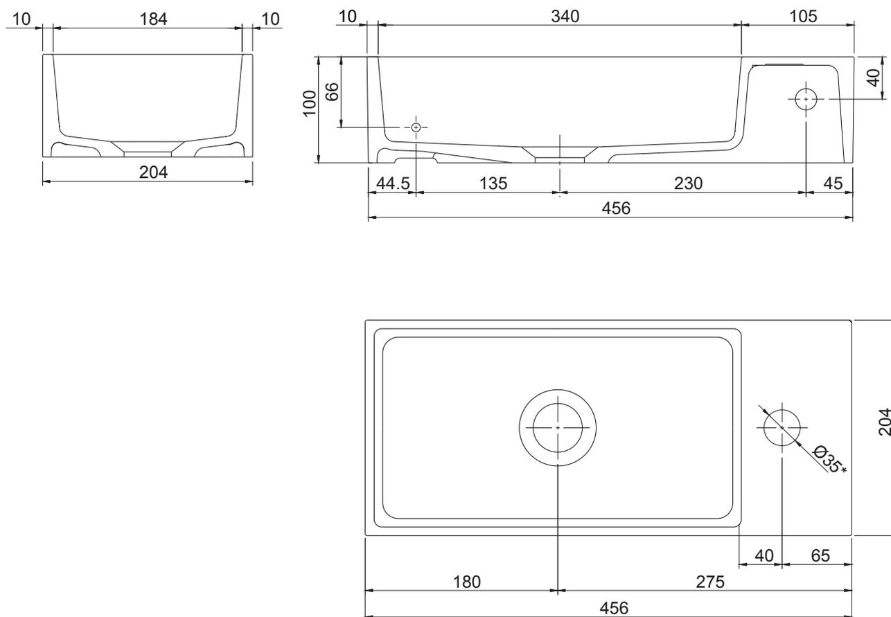
\* Dieses Maß bezieht sich auf die abgesenkte Markierung einer möglichen Hahnlochbohrung. Die Markierung befindet sich auf der Unterseite des Waschbeckens.
