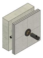
Befestigen Sie den Wandanschlussbogen mit der Madenschraube auf der Unterseite. Nutzen Sie dazu den Innensechskantschlüssel.
