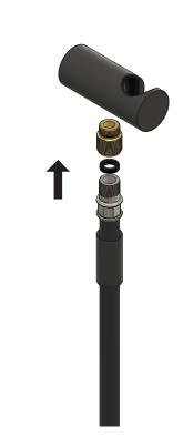
Schrauben Sie die Düse auf den Anschluss des Schlauchs. Setzen Sie dazu die Flachdichtung in das Gewinde.
